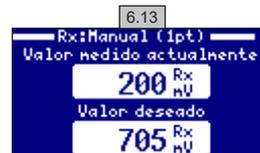
**6.13** Sin sacar la sonda del agua, fije con las teclas más/menos el ajuste de la lectura para coincida con su valor de referencia (fotómetro u otro medidor).
