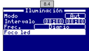
**8.4 Foco led:** En caso de disponer de focos led instalados en su piscina entre en el menú para configurar la iluminación.
