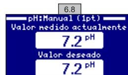
**6.8 Sin sacar la sonda del agua,** fije con las teclas más/menos el ajuste de la lectura para que coincida con el valor de referencia (fotómetro u otro medidor).
