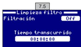
**7.5 Modo limpieza de filtro** (y limpieza de la piscina por succión): Desde este menú (accesible desde cualquier Modo de Filtración) se puede realizar de forma fácil una limpieza a contracorriente del filtro de arena. Al activar este menú desde cualquiera de los modos de filtración (Manual, Automático, Smart), se desconectará la célula de electrólisis/hidrólisis. A continuación proceda como sigue:
