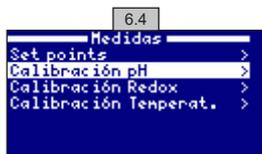
**6.4 Calibración de sonda pH:**
