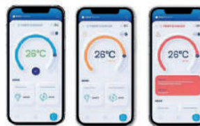
Ajuste temperatura, límite máx. temperatura, mensaje alarma
